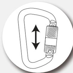
La resistencia longitudinal del mosquetón es de 41 kilo Newtons.
